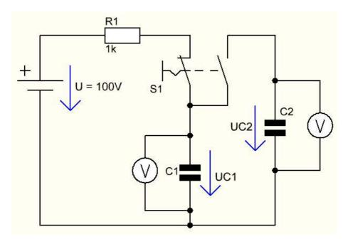
a) Im Moment des Umschaltens verhält sich der geladene Kondensator genau wie eine Spannungsquelle mit geringem Innenwiderstand. Der ungeladene Kondensator wird durch die Spannung des geladenen solange aufgeladen, bis die Ladung ausgeglichen ist.
