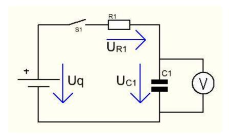
e) Um den Graph zu zeichnen, nutzt man zwei Dinge. Zum einen die Zeitkonstante τ, die bereits bestimmt worden ist, zum Anderen die Eigenschaft, dass die Schaltung mit 100 V betrieben wird. Die 100 V können mit einer Kondensatorladung von 100 % gleichgesetzt werden. Daraus ergeben sich die benötigten Werte für das Diagramm.
