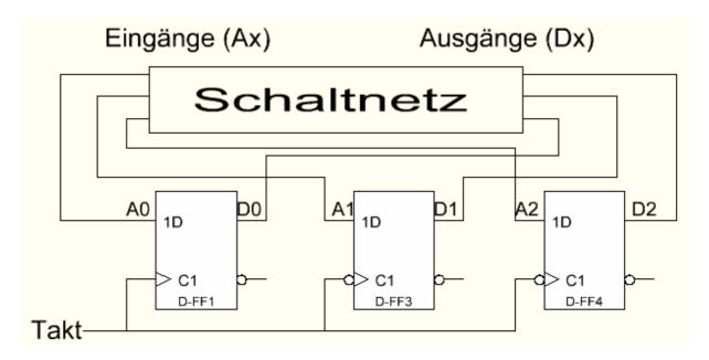
Merke: Synchronzähler, weil alle Flipflops mit dem gleichen Taktsignal versorgt werden.
