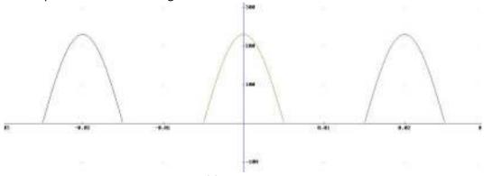
Der Graph zeigt, dass die Funktion U(t) gerade ist, also keine Sinus-Anteile besitzt. Somit entfällt die Berechnung des Fourier Koeffizienten  $b_k$ . Außerdem kann man hier bei der Integralberechnung einfach das halbe Intervall berechnen und jenes Integral verdoppeln. Außerdem kann man die Periodenlänge des Integrals auf  $T=\frac{1}{100}s$  ändern, weil der Rest sowieso Null würde. Dies gilt nur für die Integralgrenzen!!
